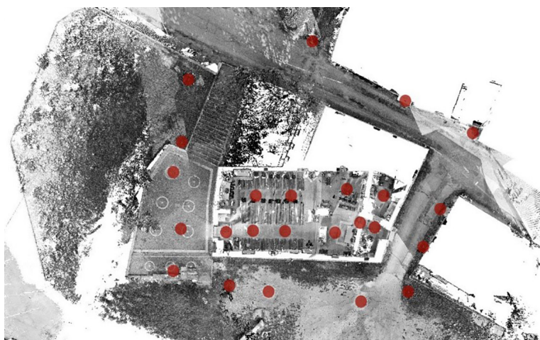
Fig. 16. Nuvola di punti della chiesa di San Menna (AQ) acquisita con il laser scanner: pianta con individuazione dei punti di stazione. (Immagine elaborata durante il corso di Rilievo e modellazione digitale dell'architettura, DICEAA, UnivAq, A.A. 2019-20. Studenti: A. Agrusti, R. Battista, G. Ciuca, F. Miconi, D. Serpetti, S. Zonfa. Docente: Ilaria Trizio Tutor: A. Tata, A. Ruggieri).
