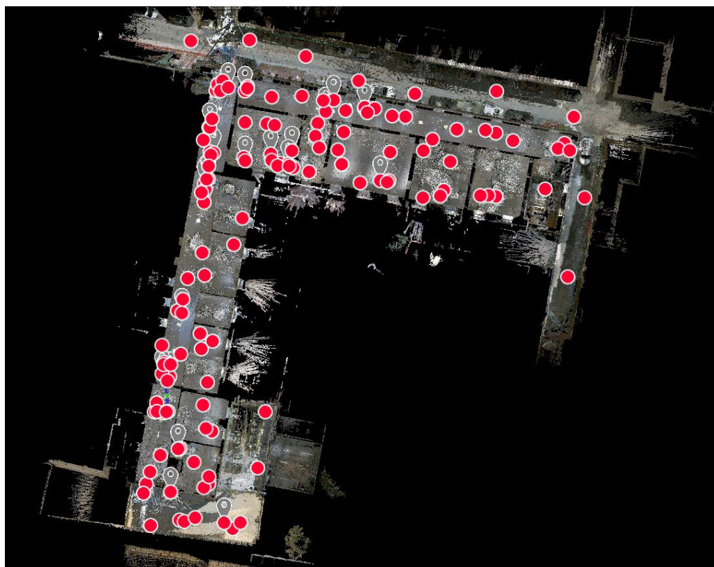
Fig. 60. Nuvola di punti di Palazzo Camponeschi da scanner mobile. Vista in pianta con indicazione dei setup e dei geotag aggiuntivi scattati durante la fase di rilevamento.
