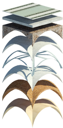
Fig. 35. Modello HBIM di una volta a crociera con stratigrafia delle componenti. Dall'alto verso il basso: pavimento in graniglia, strato autolivellante, strato di riempimento, maglia in fibra di vetro annegata in uno strato di malta, volta in laterizi, intonaco di finitura.
