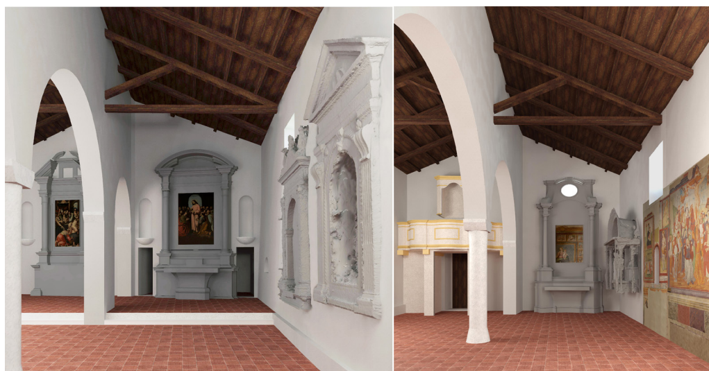
Fig. 21. Modello HBIM della chiesa di San Menna (AQ) costituito da famiglie parametriche BIM, oggetti nurbs ed elementi mesh. (Immagine elaborata durante il corso di Rilievo e modellazione digitale dell'architettura, DICEAA, UnivAq, A.A. 2019-20. Studenti: A. Agrusti, R. Battista, G. Ciuca, F. Miconi, D. Serpetti, S. Zonfa. Docente: Ilaria Trizio Tutor: A. Tata, A. Ruggieri).
