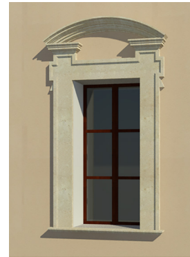
Fig. 63. Apertura sul prospetto principale: nuvola di punti derivante dal rilievo SfM e famiglia parametrica modellata in Autodesk Revit.
