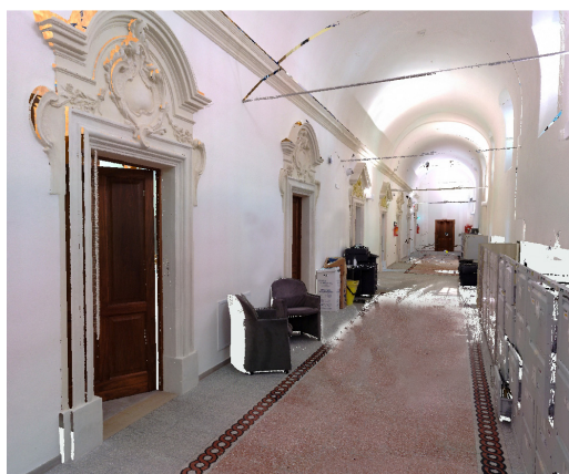
Fig. 59. Nuvola di punti di Palazzo Camponeschi da laser scanner. Viste del cortile interno, della scala monumentale e di un corridoio del piano seminterrato.
